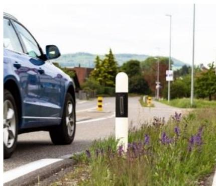
Abbildung 1: Zählgerät als Leitpfosten
